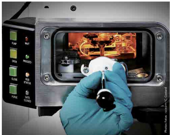
Mit dem Rasterelektronenmikroskop Neon 40 können SCHOTT Forscher komplexe Fragen der Entwicklungs- oder Schadensanalytik nun schneller beantworten. Die Bilder rechts zeigen das Einbauen einer Probe.
